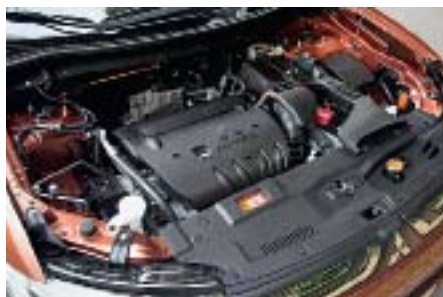
Моторы пока только проверенные бензиновые атмосферные, объемом 2,0 и 2,4 литра
