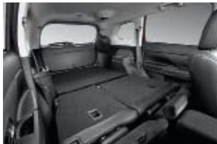
Благодаря новому механизму складывания сидений багажник стал на 335 мм длиннее
