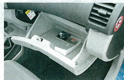
▲ ПЕРЧАТОЧНЫЙ ЯЩИК – это неудобное неглубокое выдвижное корытце. Внутри на стенке слева – скважина отключения фронтальной подушки безопасности
