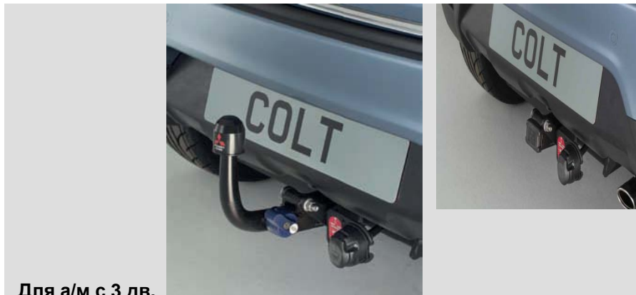
Для а/м с 3 дв. MZ314253 Прицепное устройство съемное. Горизонтальная нагрузка 750 кг., вертикальная нагрузка 50 кг.
