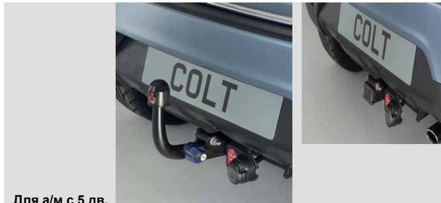
Для а/м с 5 дв. MZ314254 Прицепное устройство съемное. Горизонтальная нагрузка 1000 кг., вертикальная нагрузка 50 кг.
