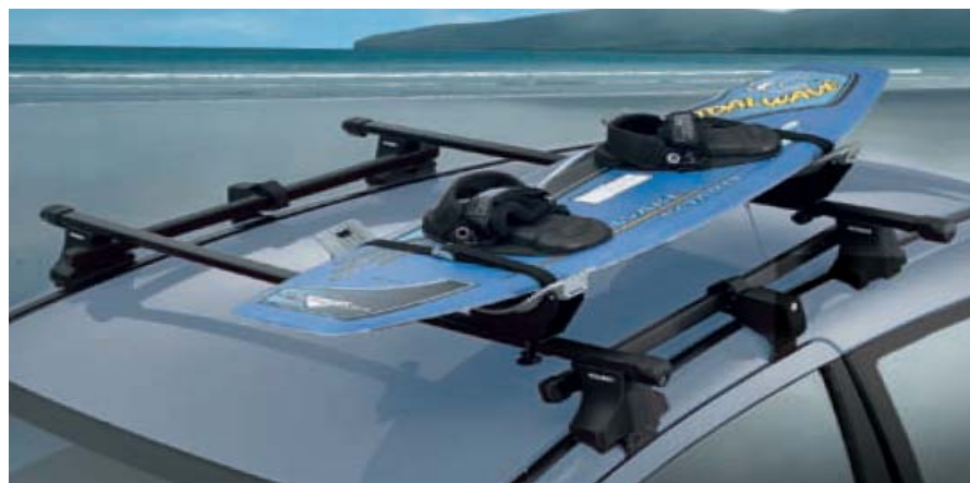
MZ313408 Дуги поперечные для 3 дв. а/м Максимальная нагрузка 50 кг.
