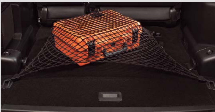
MZ312254 Сетка для крепления груза в багажнике. Крепится за крюки в багажнике
