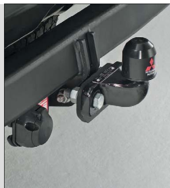
MZ314240 Прицепное устройство фиксированное. Горизонтальная нагрузка 2500 кг., вертикальная нагрузка 100 кг.
