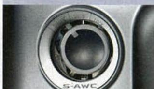
S-AWC, подразумевающая возможность выбора степени блокировки дифференциала в зависимости от дорожного покрытия.
