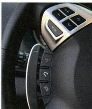
**▲ Стильные ПОДРУЛЕВЫЕ ЛЕПЕСТКИ** позволяют переключать виртуальные передачи вариатора вручную
