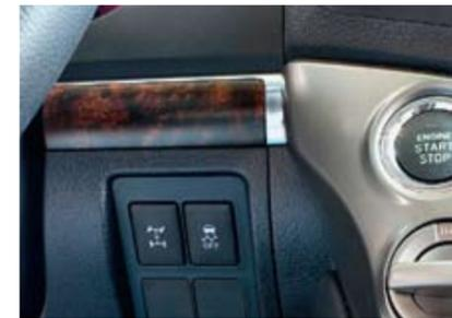
Понижающая передача на TLC 200 включается поворотной рукояткой, а блокировка «центра» — клавишей
