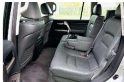
Сиденья второго ряда имеют регулировку наклона спинки и откидной подлокотник
