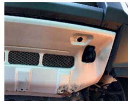
Штатная защита на Рајего исправно выполняет свою работу, прикрывая моторный отсек
