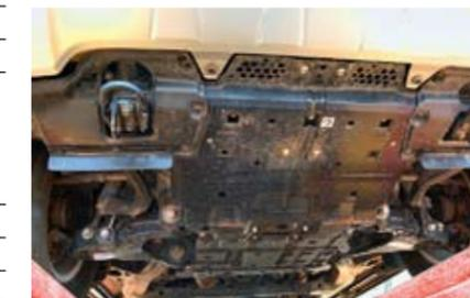
Снизу Land Cruiser прикрыт по максимуму — где сталью, а где пластиком
